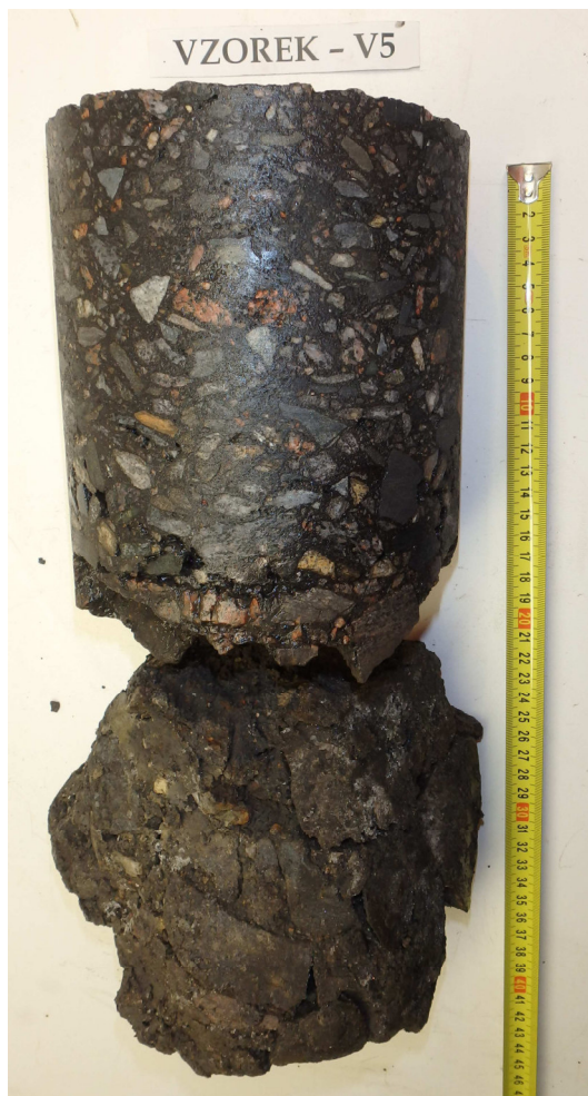
Obr. 10 - Jádru vývrtu Vzorek – V5 (laboratoř).
