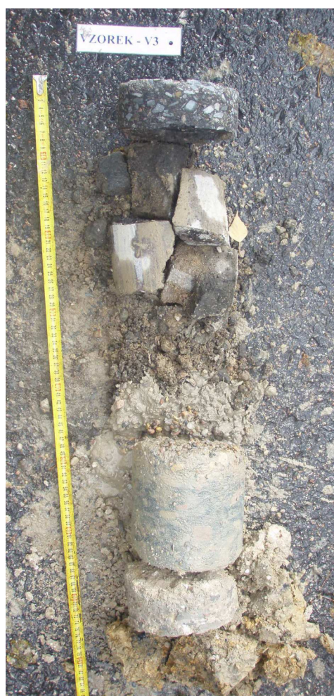
Obr. 5 - Jádru vývrtu Vzorek – V3 (in situ).
