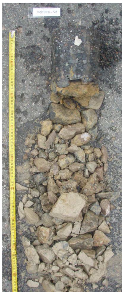
Obr. 3 - Jádro vývrtu Vzorek – V2 (in situ).
