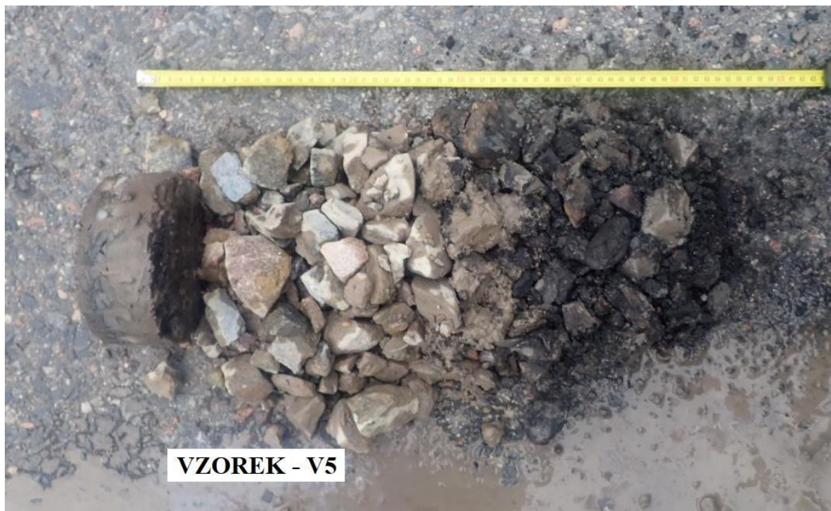
Obr. 1 - Jádro vývrtu Vzorek – V5 (in situ).
